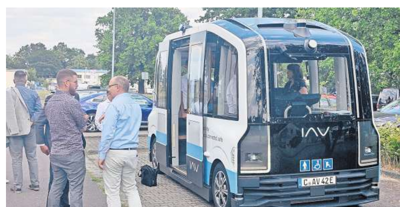
Dieser Bus der Firma IAV rollt bereits jetzt zu Testzwecken auf dem Flugplatz. Er nutzt Kameras und Sensoren, um ohne Mensch am Steuer zu fahren.
